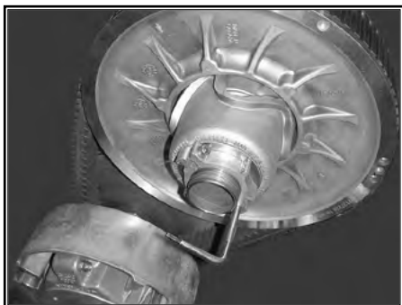
ПРИСПОСОБЛЕНИЕ ДЛЯ РАЗВЕДЕНИЯ ШКИВА ВСТАВЛЕНО В РЕГУЛИРОВОЧНУЮ МУФТУ
