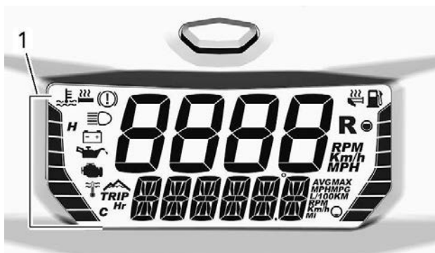
1. Левый указатель панели приборов
