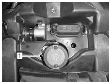
1. Компенсационный бачок заднего тормоза
