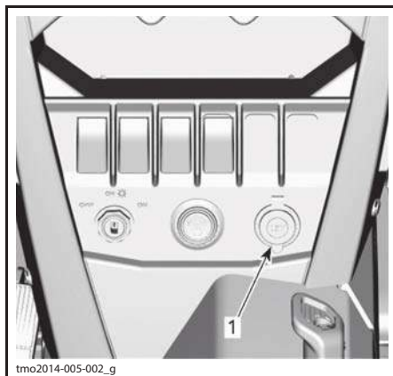
1. Электрическая розетка (12 В)
