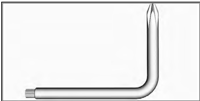
ПРИСПОСОБЛЕНИЕ ДЛЯ РАЗВЕДЕНИЯ ШКИВА ВАРИАТОРА
